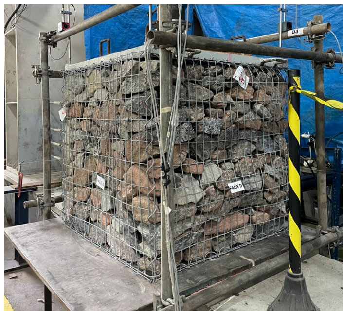
Ensaio de compressão do gabião Easy S Seção de Obras Cívicas do IPT/SP
